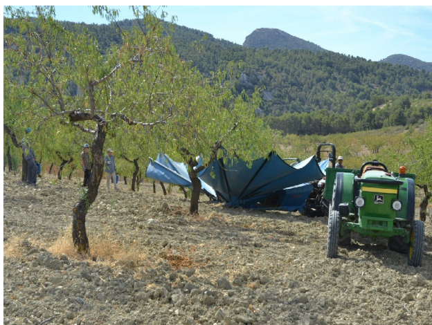
Der høstes mandler: maskinen folder en paraply rundt om træet, ryster så træet; maskinen folder paraplyen sammen og tømmer den ned i en lastbil.
