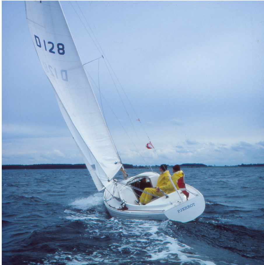
PJERROT, Int. H-båd D-128 (bygget 1975 af Elvström) loa: 8,28 m - bredde: 2,18 - dybdegang: 1,30 m - depl.: 1,4 ton
