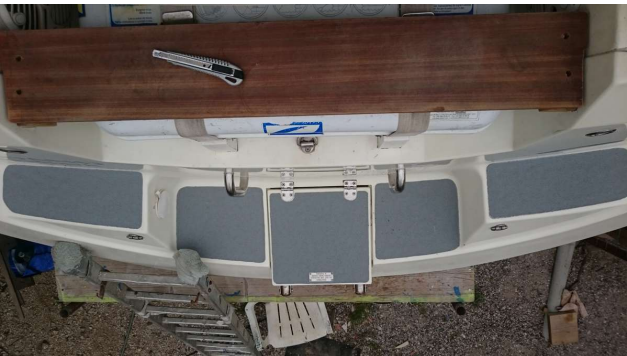
Så er der lagt skridmønster på hækken; den brune planke øverst i billedet er den planke Sten lavede over redningsflåden
