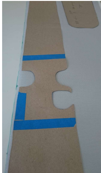
Der laves skabeloner til dækket
